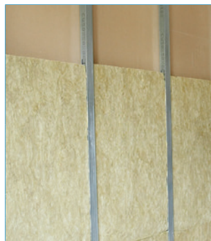
Termarock® 100 Feuerschutzplatte Euroklasse A1, Mindestrohdichte 100 kg/m 3 , Wärmeleitfähigkeit \lambda = 0,035 W/(m·K)
