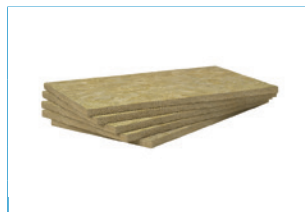
RAF Schallschluckplatte Euroklasse A1, Wärmeleitfähigkeit \lambda = 0,040 W/(m·K)
