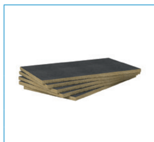
RAF-SE Schallschluckplatte, einseitig mit schwarzem Glasvlies kaschiert Euroklasse A1, Wärmeleitfähigkeit \lambda = 0,040 W/(m·K)
