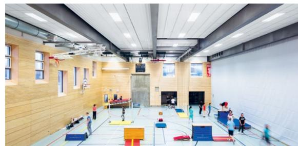
Eine vollflächige, höchstabsorbierende und ballwurfsichere Deckenfläche unterstützt den Sportunterricht optimal. (Foto: HG Esch Photography)
